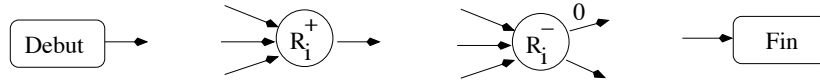
FIGURE 2 – Un arc sortant indique la suite du programme à exécuter. L’arc sortant, labellé 0, de l’opération de décrément indique la suite du programme lorsque le contenu du registre R_i est nul (avant décrément).
